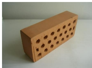
Figura - Esempio di mattone semipieno 15\% < \leq 45\% in laterizio per murature portanti 3
