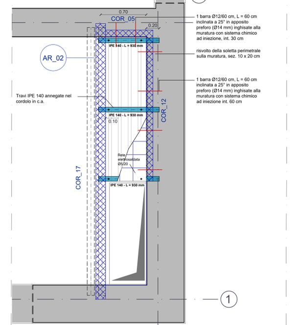
SCHEMA DI DISPOSIZIONE DEI CONNETTORI SULLE TRAVI
