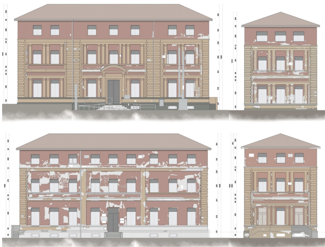
Fig. 11 Prospetti e rilievo del degrado materico
