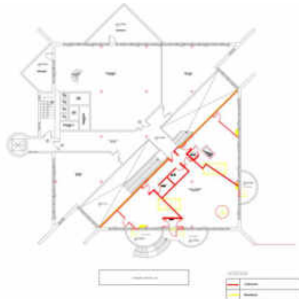
FIGURA 4: PLANIMETRIA CON RAPPRESENTAZIONE DEGLI ELEMENTI DA DEMOLIRE (GIALLO) E DA COSTRUIRE (ROSSO)
