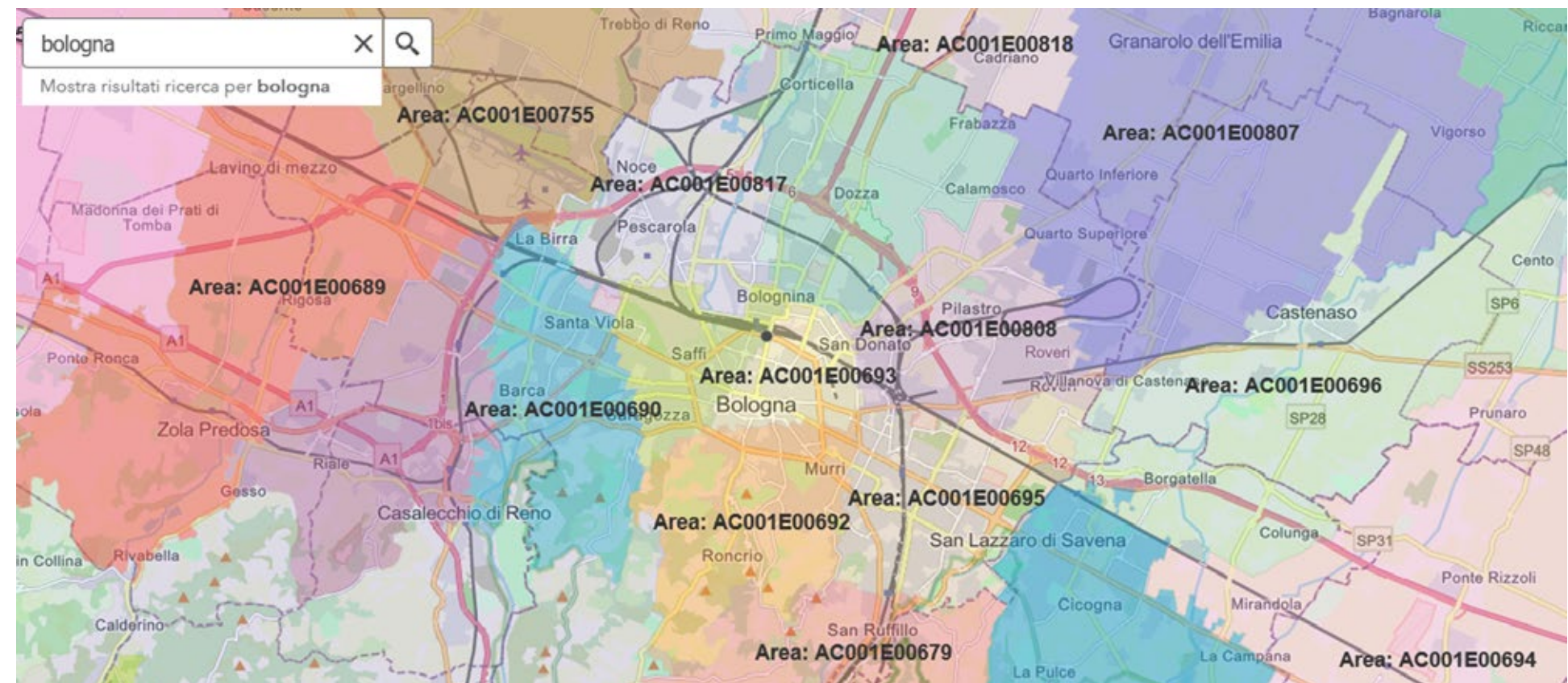
Figura 4.3 – Aree associate alle cabine primarie di trasformazione relative alla città di Bologna. Dato e-distribuzione.
