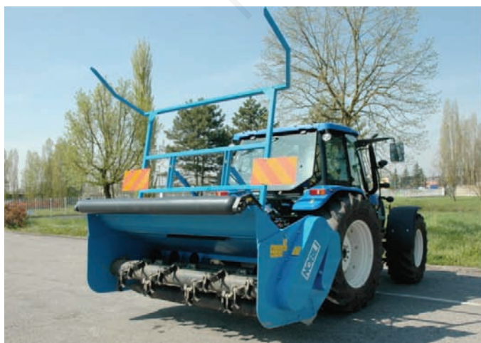
Figura 2. Macchina per il taglio, sfibratura e andanatura dell'Arundo, secondo prototipo Biotrituratore RM280BIO .
